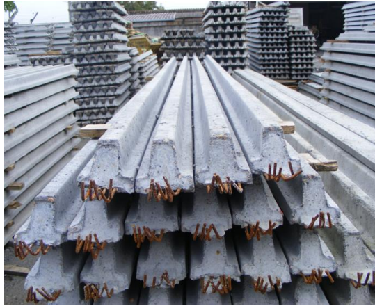
Figura 3 – Vigota de concreto armado
