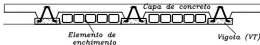
Figura 15 – Corte em laje de vigota treliçada
