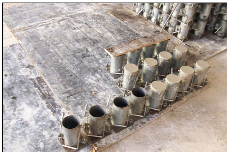
Figura 34 - Execução de corpo de provas
