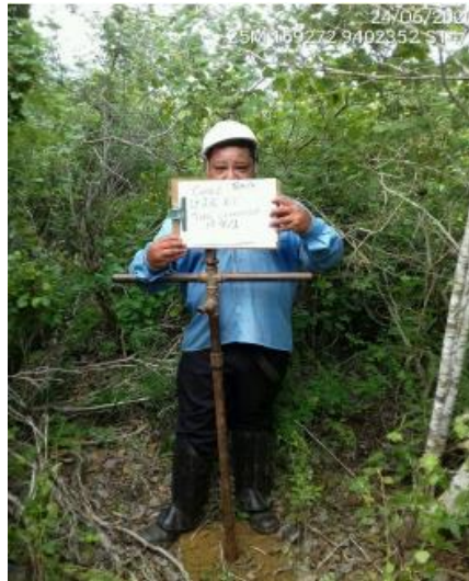
Figura 3: Sondagem à Trado
