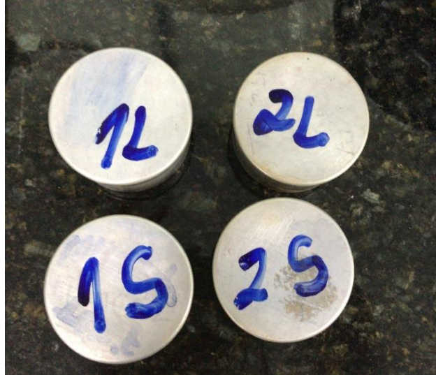
Figura 28 – Cápsulas utilizadas na determinação da umidade higroscópica do solo
