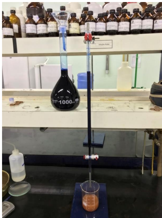
Figura 23 – Realização do ensaio azul de metileno
