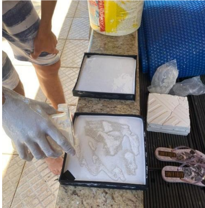
Figura 28 - Placa feita com gesso rápido homogêneo e pó de gesso reciclado
