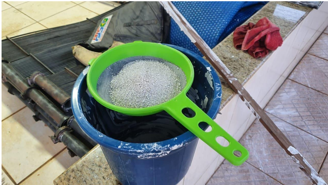
Figura 24 - Peneiração do gesso triturado
