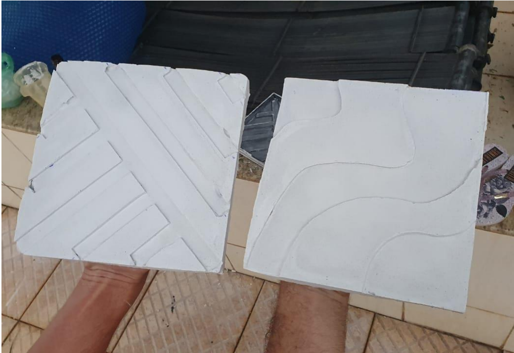
Figura 25 - Placas de Gesso 3D produzida com gesso rápido em pó
