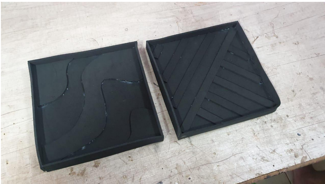
Figura 23 - Fôrmas confeccionadas com E.V.A.
