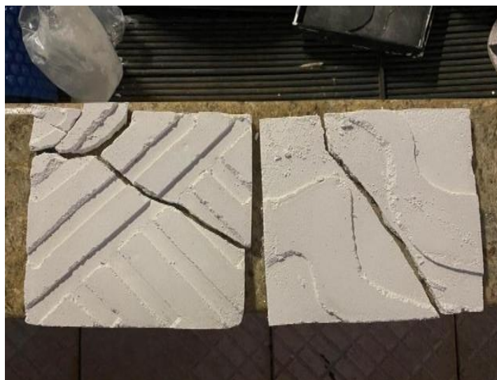
Figura 27 - Placa de gesso trincada, feita de gesso rápido e reciclado.
