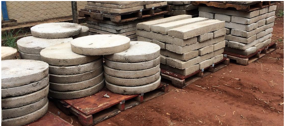
Figura 16 - Areia reciclada aplicada em artefatos e tampas de bueiros.
