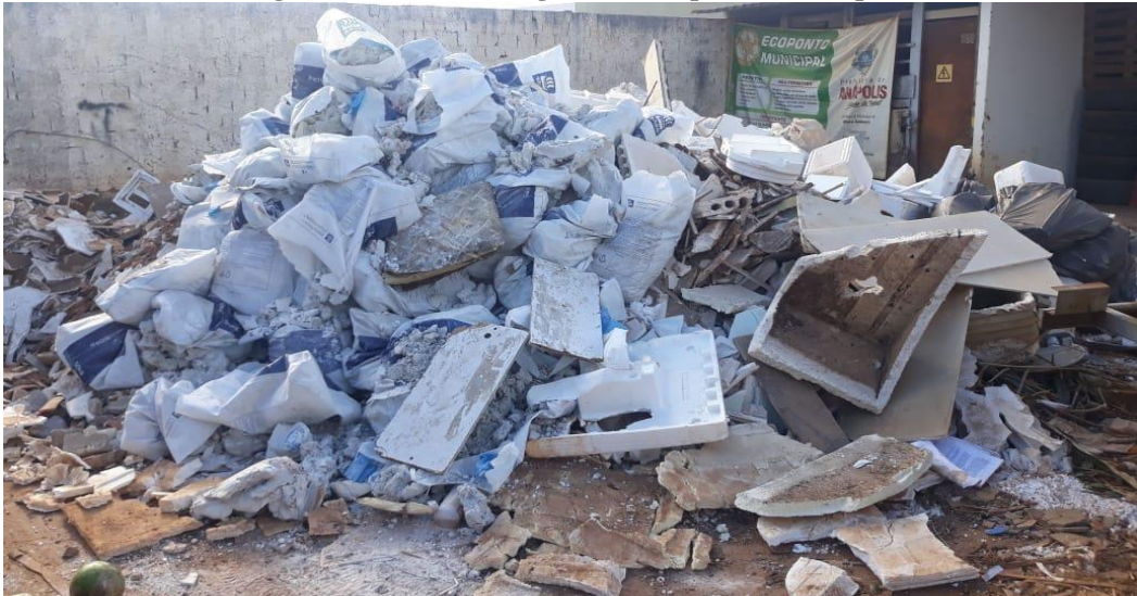
Figura 4 – Resíduos de gesso no Eco ponto de Anápolis
