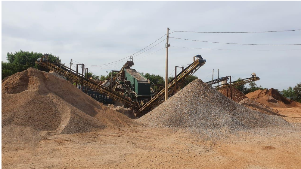
Figura 19 - Separação de material reciclado conforme a granulometria
