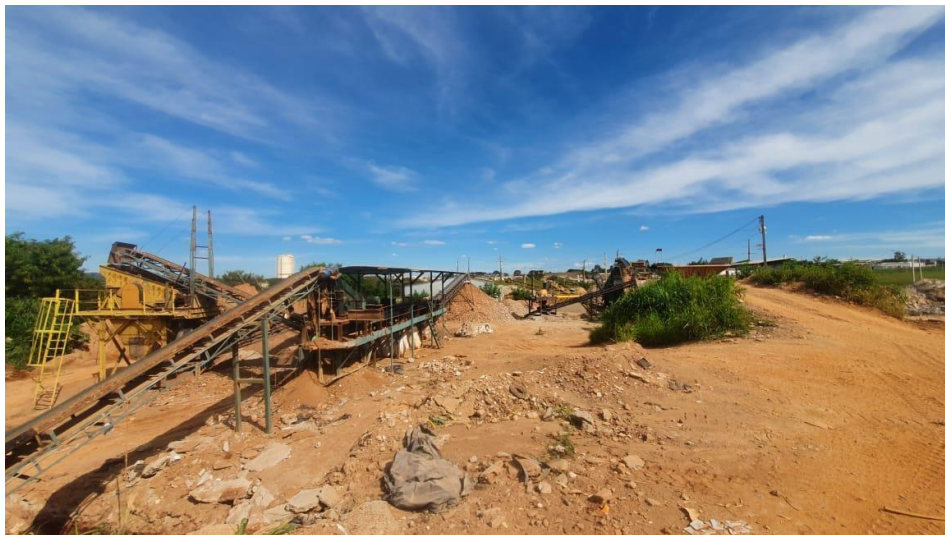
Figura 18 - Esteira de separação de RCD
