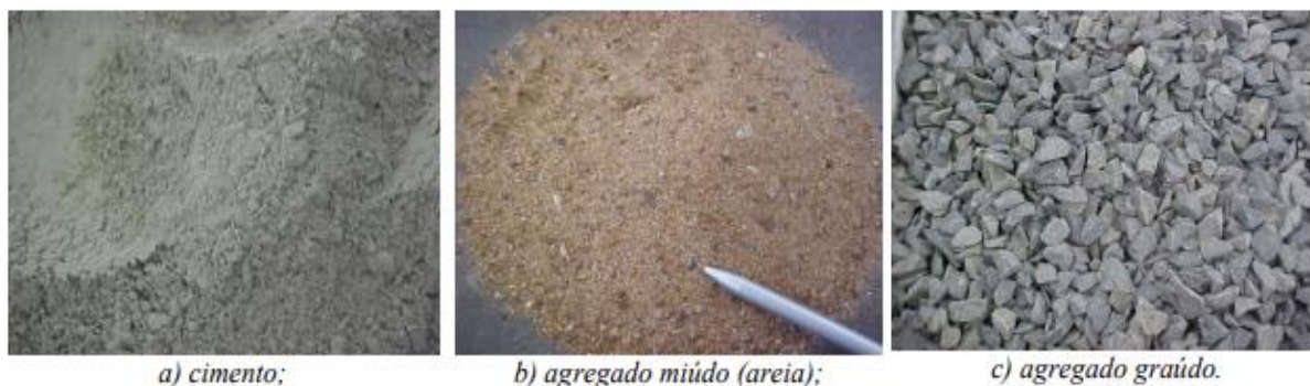
Figura 1 - Materiais constituintes do concreto.
