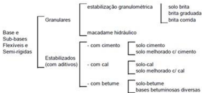
Figura 6 - Classificação das bases e sub-bases flexíveis e semi-rígidas
