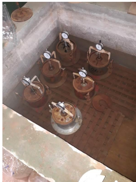
Figura 16 - Tanque de imersão.
