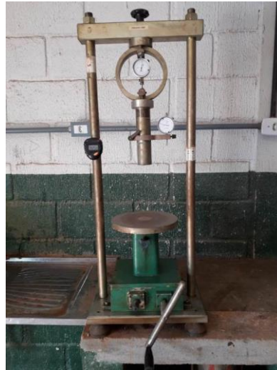
Figura 17 - Prensa para determinação do ISC.
