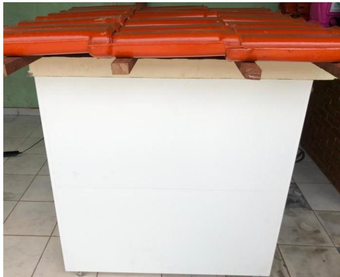
**Figura 18 - Telha cerâmica + forro termo painel**
