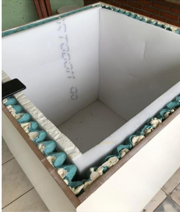
**Figura 16 - Caixa acústica revestida com caixa de ovo e espuma**
