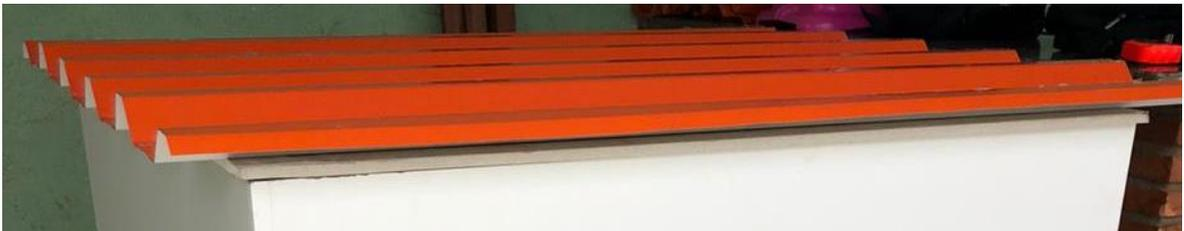
**Figura 27 - Telha metálica + forro gesso acartonado**
