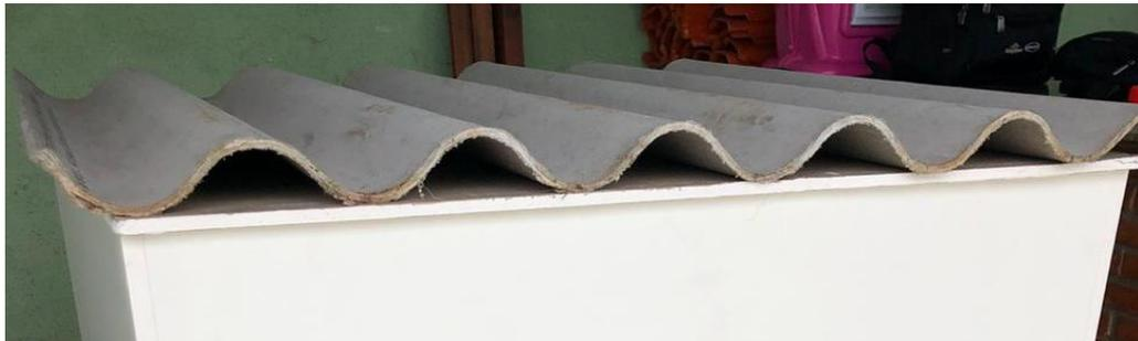
**Figura 31 - Telha fibrocimento + forro gesso acartonado**
