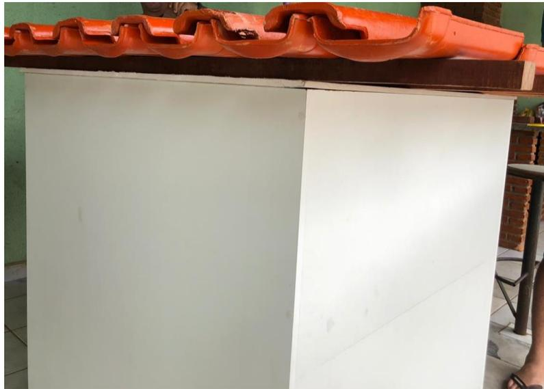
**Figura 19 - Telha cerâmica + forro gesso acartonado**
