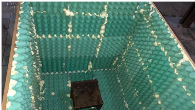
**Figura 15 - Caixa acústica revestida com caixa de ovo**
