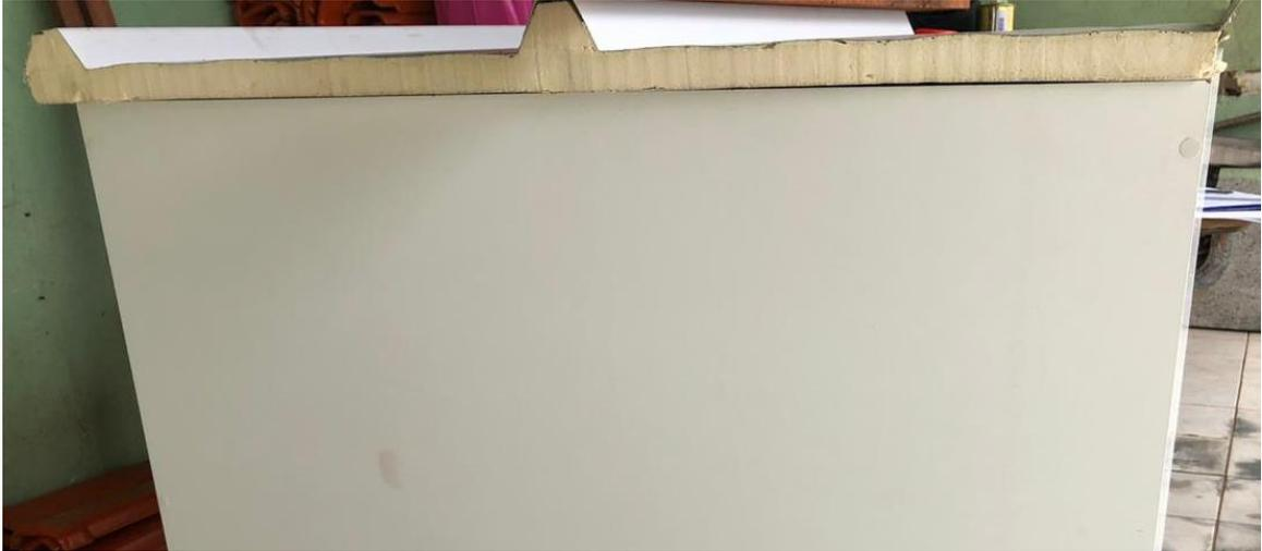
**Figura 21 - Telha termoacústica**
