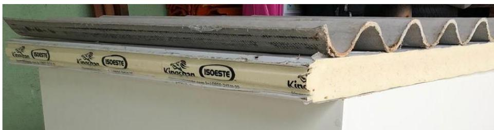
**Figura 30 - Telha fibrocimento + forro termoacústico**
