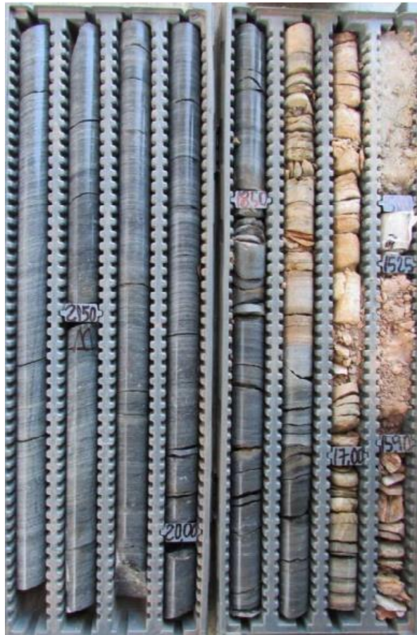
Figura 27 – Testemunhos de Sondagem Mista PCH Tamboril – SM-302 J.
