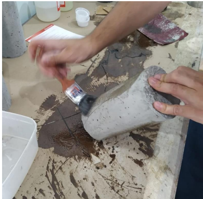
Figura 19 – Passagem de epóxi no substrato.
