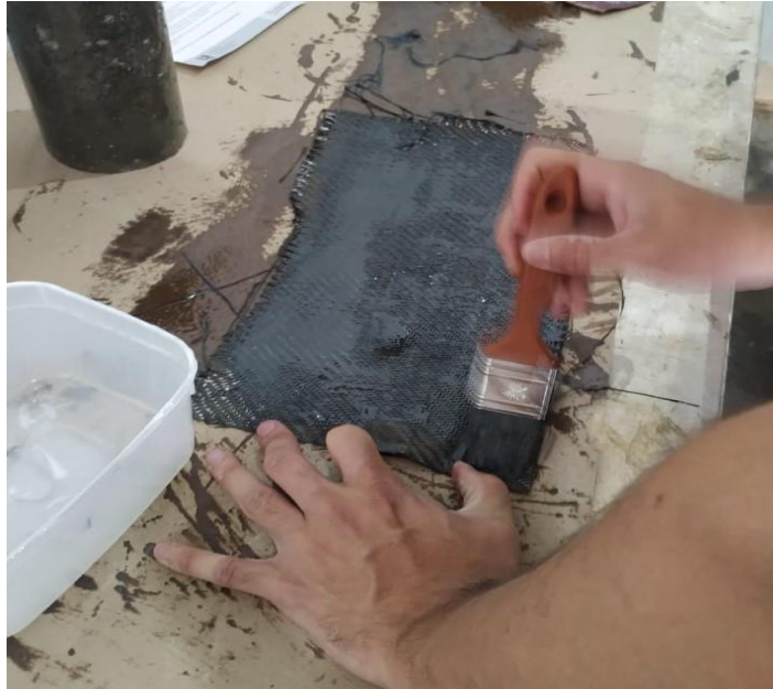
Figura 18 – Passagem de epóxi na manta.
