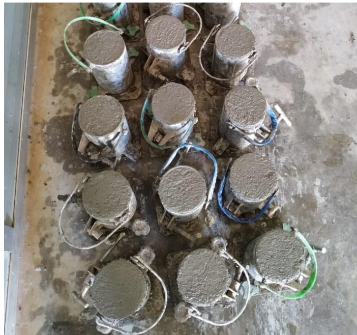
Figura 16 – Arrasamento do concreto
