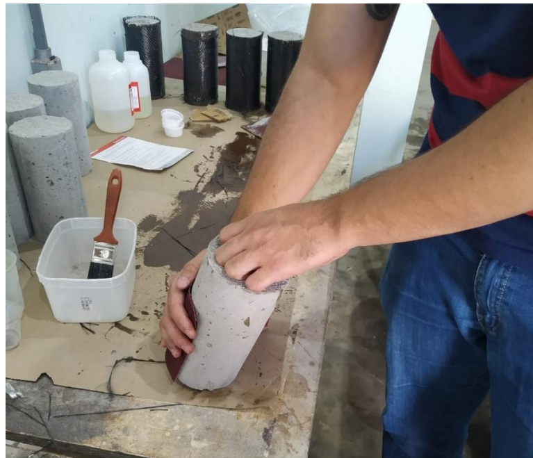
Figura 17 – Lixamento do corpo de prova
