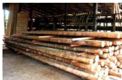
Figura 9 – Armazenamento correto das varas de bambu
