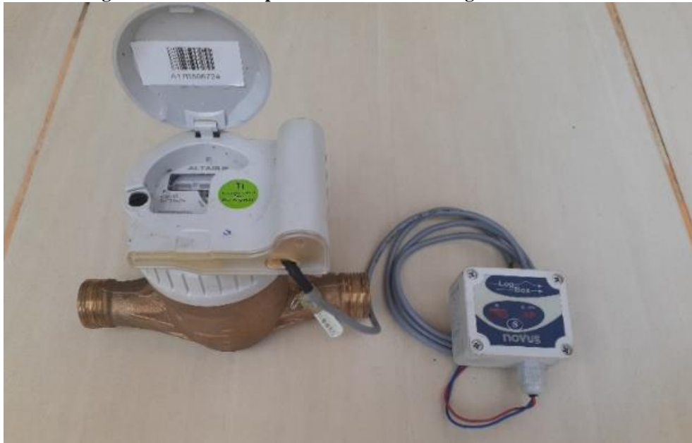
Figura 32 - Sensor acoplado ao hidrômetro e registrador de dados
