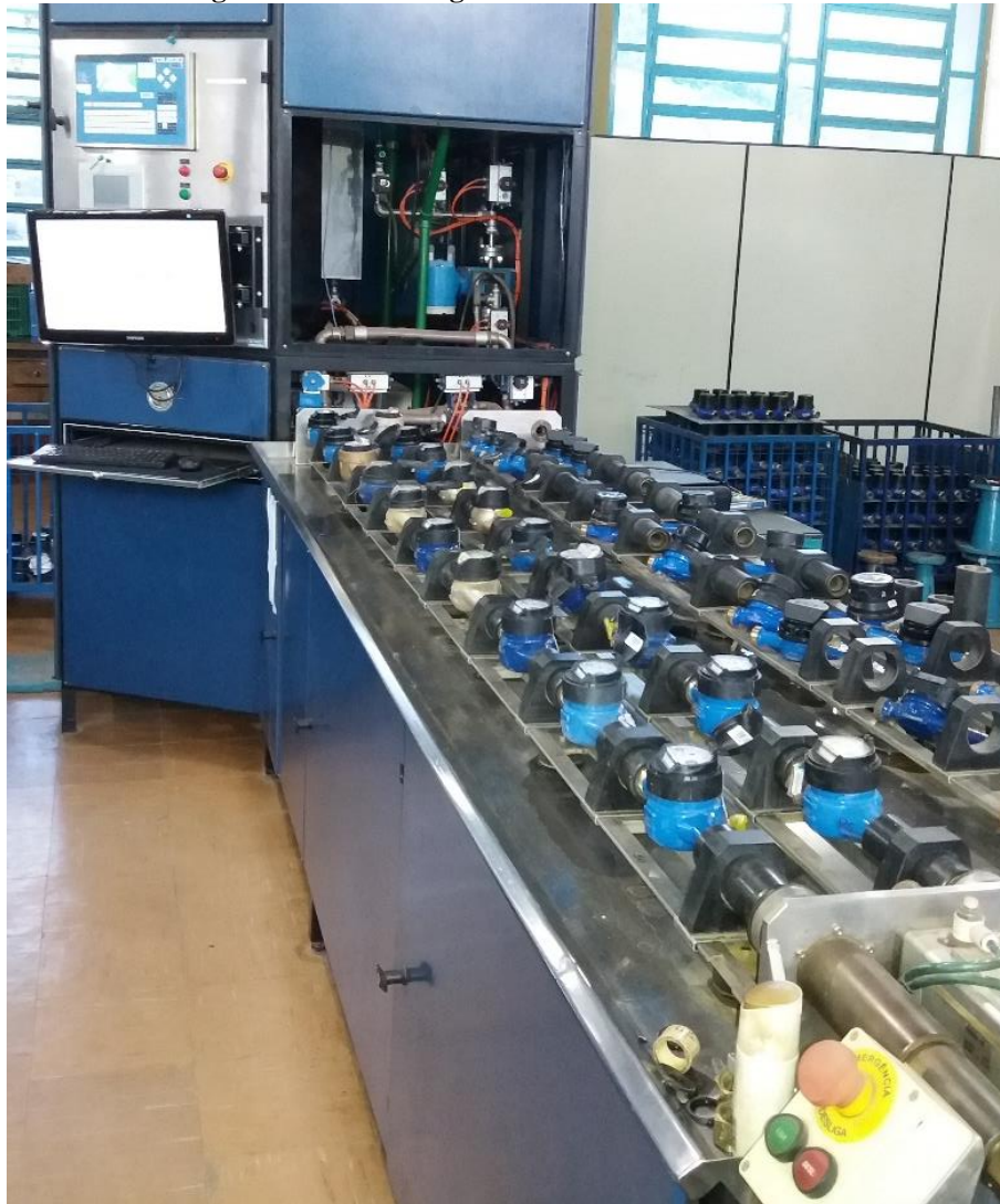
Figura 28 - Bancada gravimétrica de teste de vazão
