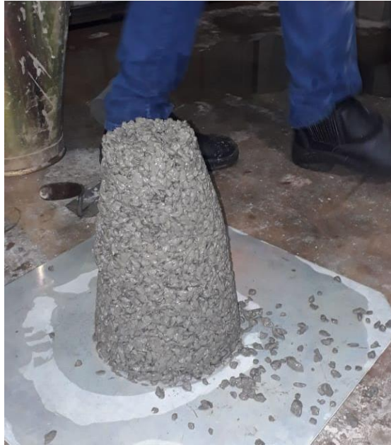
Figura 7 - Ensaio de slump test
