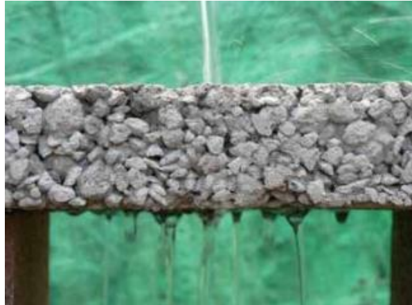
Figura 2 - Amostra de concreto permeável
