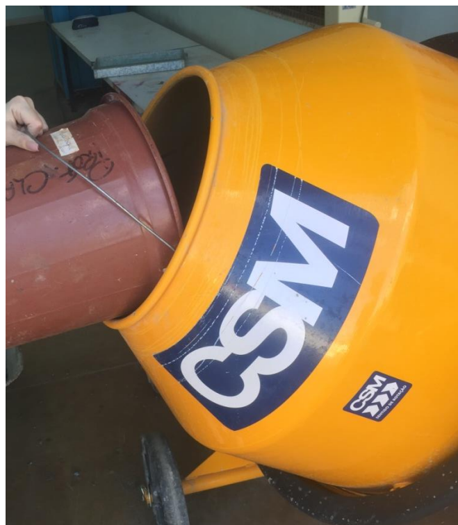
Figura 6 - Adição dos materiais na betoneira
