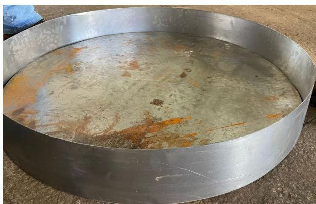
Figura 94- Tanque Classe A em processo de construção para realização do experimento.
