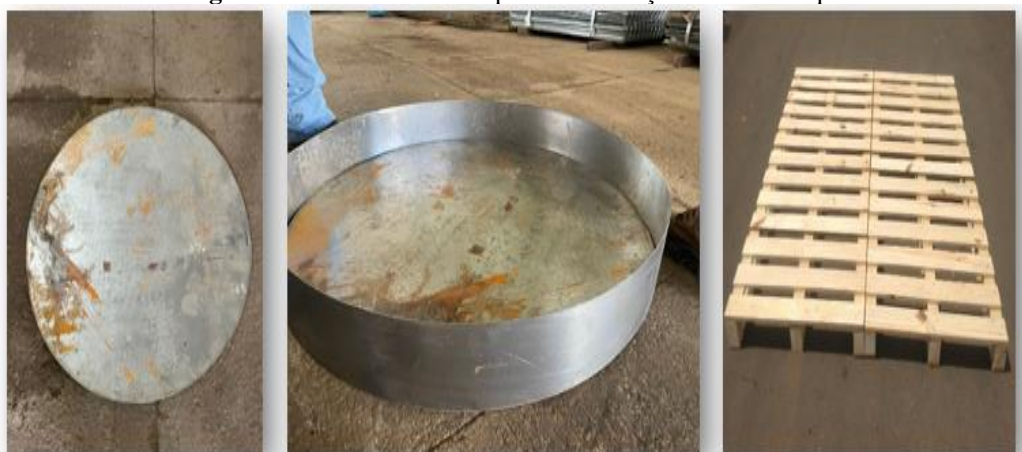
Figura 8- Material utilizado para a construção do mini tanque
