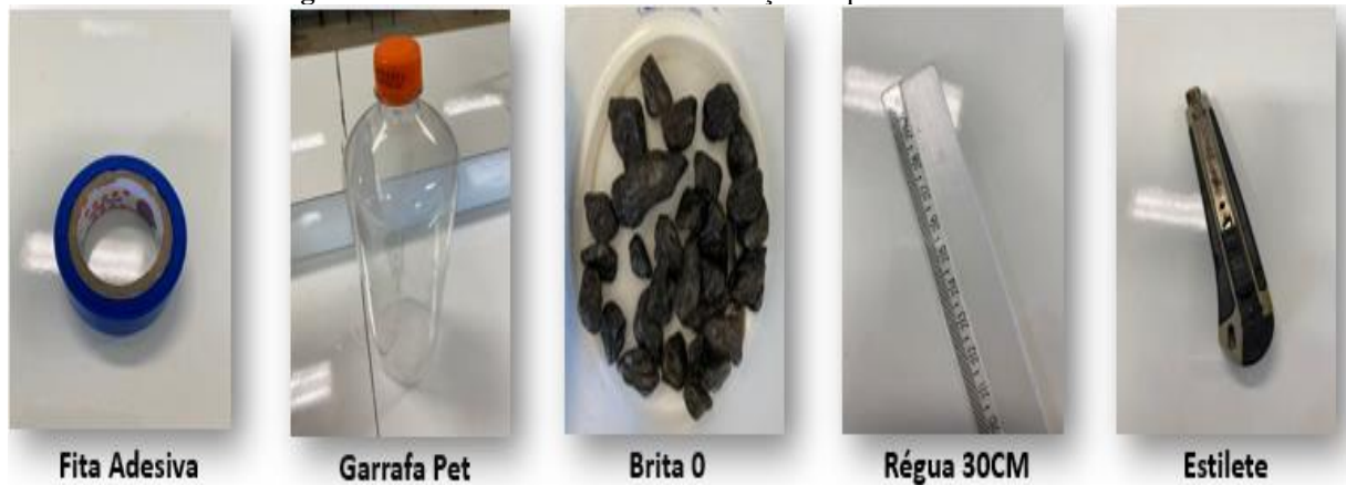
Figura 7- Materiais utilizados na construção do pluviômetro caseiro
