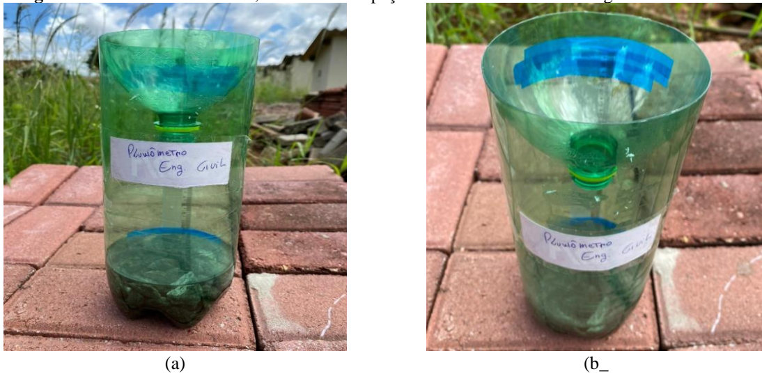
Figura 11- Pluviômetro caseiro, inserido em espaço aberto na Faculdade Evangélica de Goianésia.
