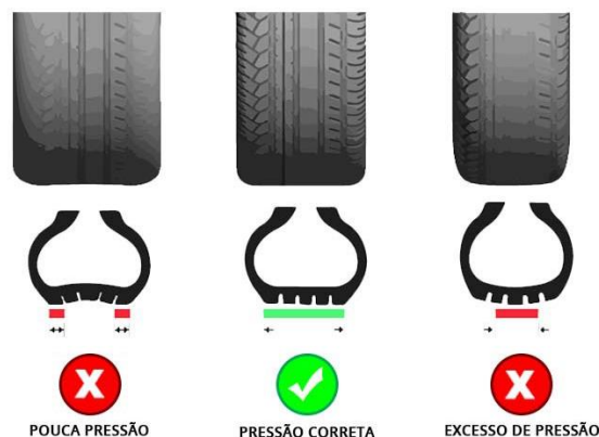
Figura 6 - Calibragem correta dos pneus
