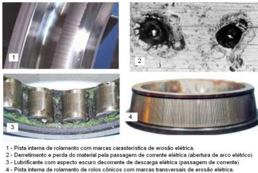
Figura 11 - Defeito em elementos rolantes.
