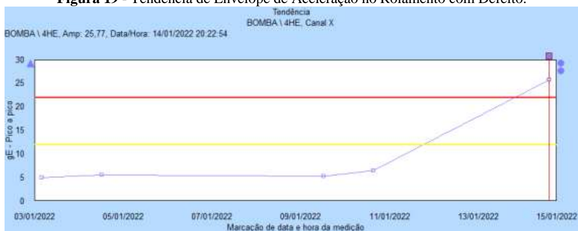
Figura 19 - Tendência de Envelope de Aceleração no Rolamento com Defeito.
