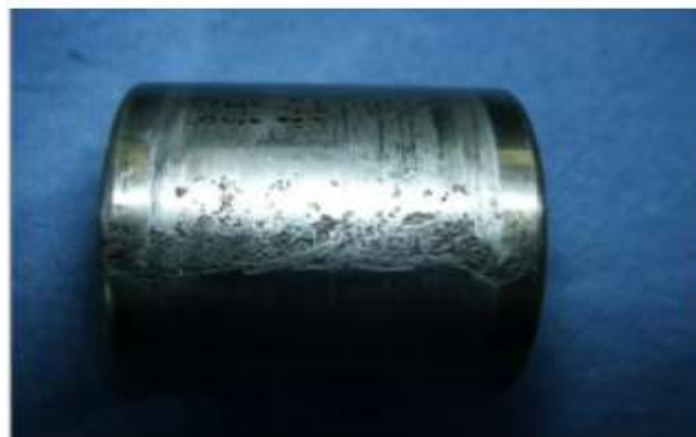
Figura 12 - Defeito no Elemento do Rolamento.
