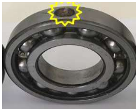
Figura 10 - Defeito na pista externa.
