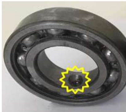
Figura 9 – Amostra de Elemento apresentando marca de erosão.
