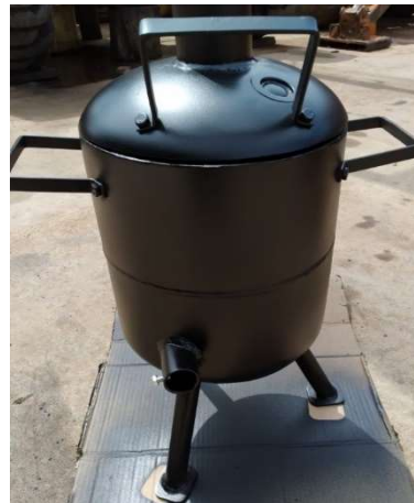
Figura 8 - Pintura do equipamento com tinta para alta temperatura
