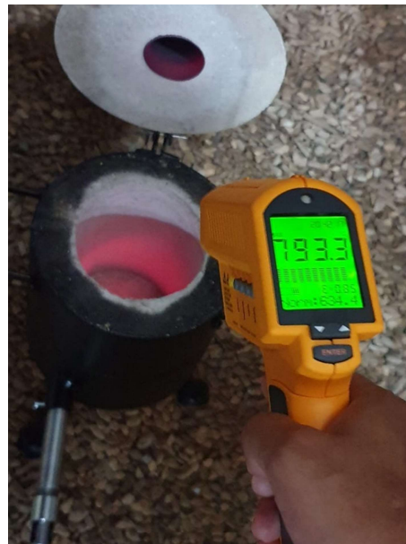
Figura 17 - Medição de temperatura com 30 minutos de funcionamento.
