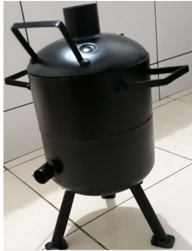
Figura 13 - Forno montado com concreto refratário aplicado
