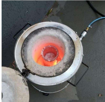
Imagem 7 – Cadinho posicionado dentro do forno.
