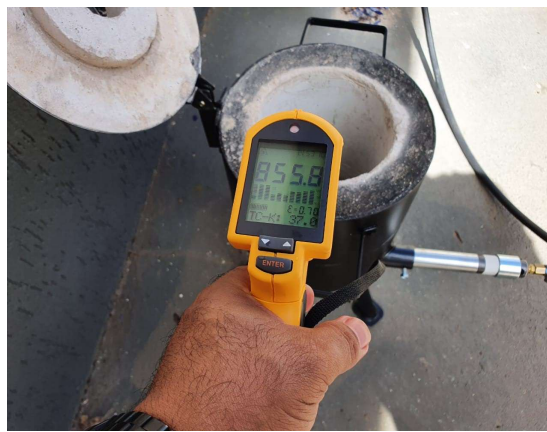
Figura 20 - Medição de temperatura com 15 minutos de funcionamento
