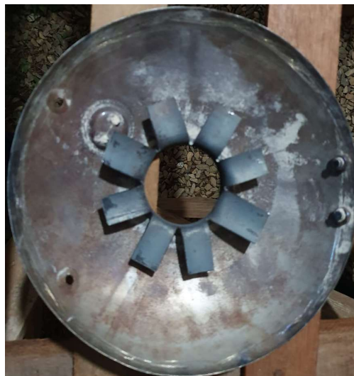
Figura 14 - Grapas para fixação do concreto refratário na tampa
