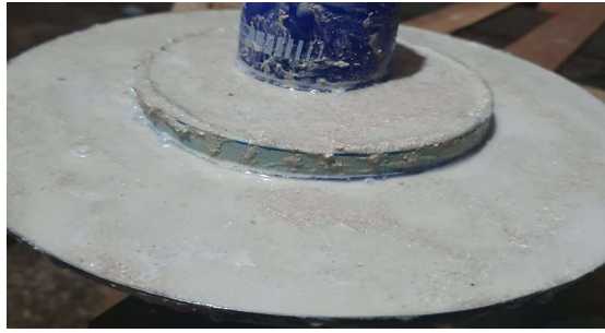
Figura 15 - Tampa após melhoria de duto e ressalto de refratário
