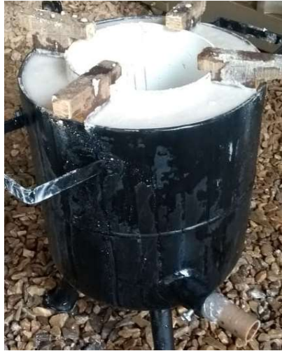
Figura 11 - Corpo do forno preenchido com concreto refratário
