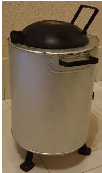
Figura 16 - Forno do equipamento com isolamento em manta fibra cerâmica
