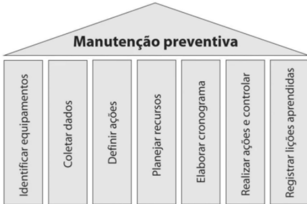
Figura 3 - Etapas da implantação da manutenção preventiva
