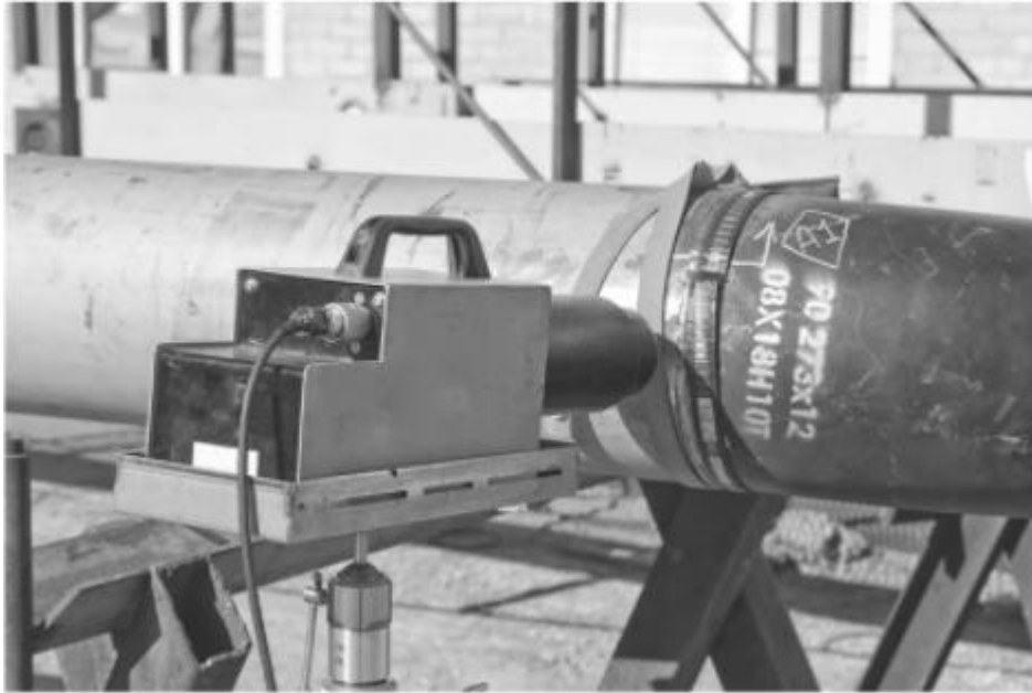
Figura 4 - Ensaio de raio x em uma junta soldada de uma tubulação de aço.
