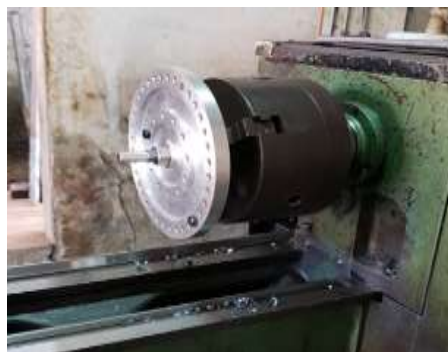
Figura 3.3 - Usinagem do disco rotor
