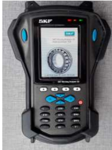
Figura 2.12 - Coletor de vibração SKF – GX 75
