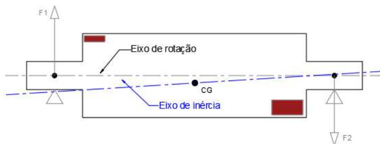
Figura 2.9 - Desbalanceamento dinâmico
