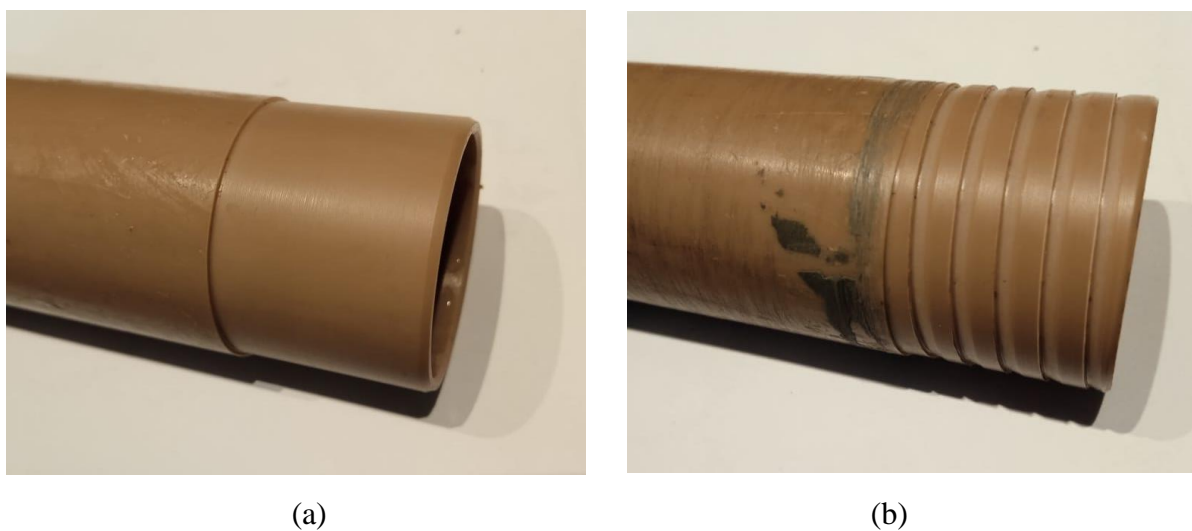
Figure 4.8 – Tubo de PVC usinado pelo protótipo. (a) – Superfície lisa; (b) – Superfície rugosa.
