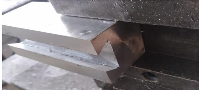
Figura 3.20 – Fabricação do barramento de deslizamento do cabeçote.
