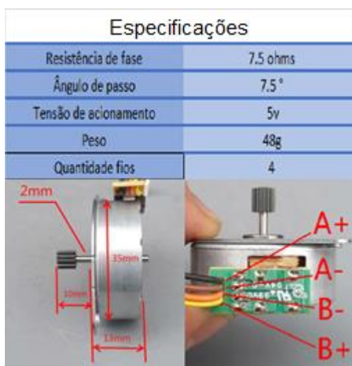
Figura 3.18 – Especificação do motor de acionamento do cabeçote.
