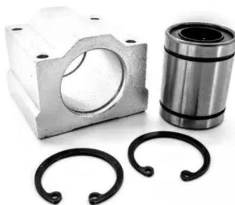
Figura 3.5 – Componentes desmontados do mancal “Pillow block”.
