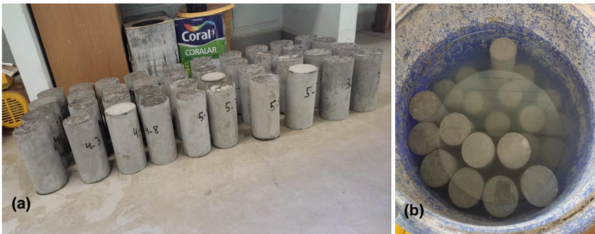
Figura 11 - Corpos de prova desmoldados (a) e processo de cura dos corpos de prova (b).
