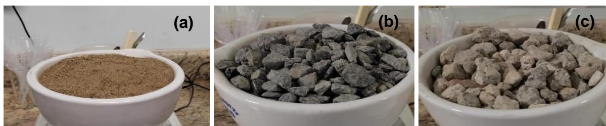
Figura 6 - Amostras no recipiente de 1 dm 3 sendo agregado miúdo (a), brita 1 (b) e brita reciclada (c).
