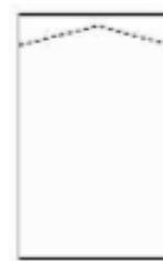
Figura 4.7 – Tipo G – Similar ao tipo F – com fraturas próximo ao topo
