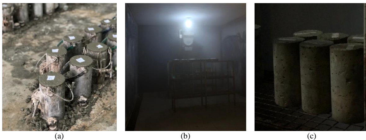
Figura 31 – Cura do concreto. Cura inicial (a); Câmara úmida (b); corpos de prova em processo de cura (c).
