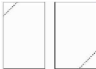
Figura 4.6 – Tipo Fraturas no topo e/ou na base abaixo do capeamento
