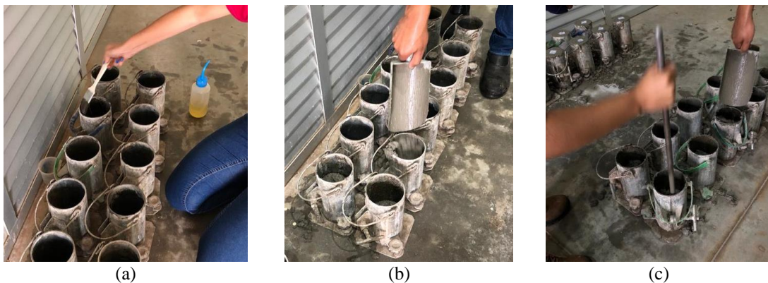
Figura 30 – Moldagem dos corpos de prova. Lubrificação (a); inserção do concreto nos moldes (b); adensamento do concreto (c).
