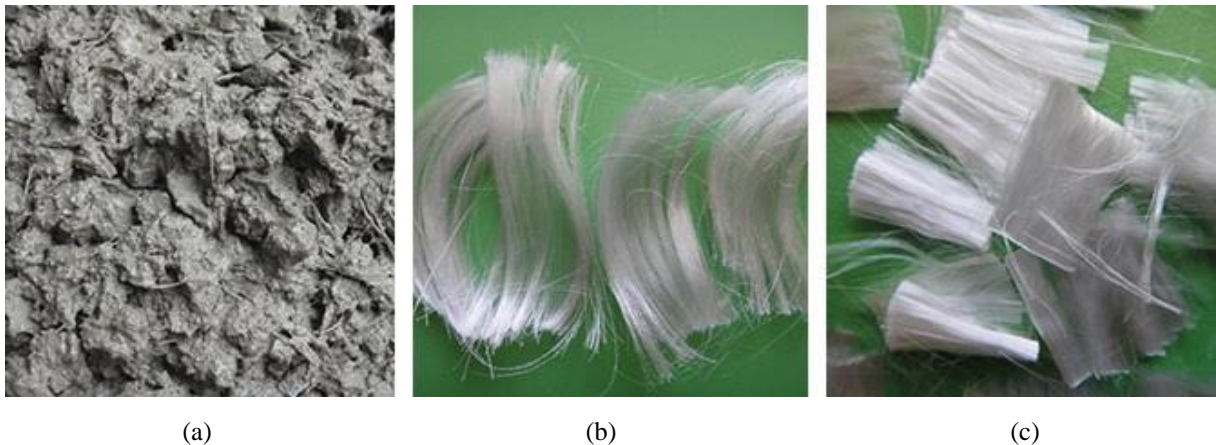
Figura 7 – Amostra do concreto com adição de fibras de Polipropileno (a) e amostra das fibras de Polipropileno (b) e (c).
