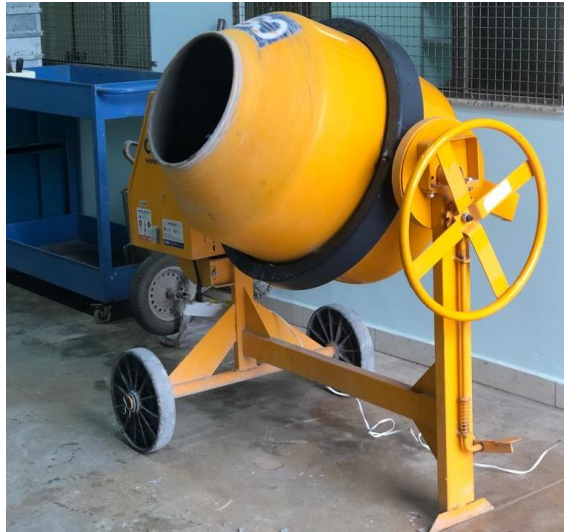
Figura 28 – Equipamento betoneira utilizado na confecção do concreto.
