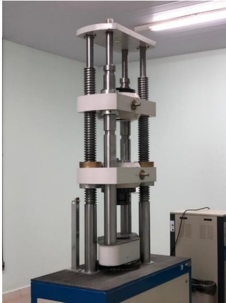
Figura 32 - Prensa para ensaio de resistência à compressão.
