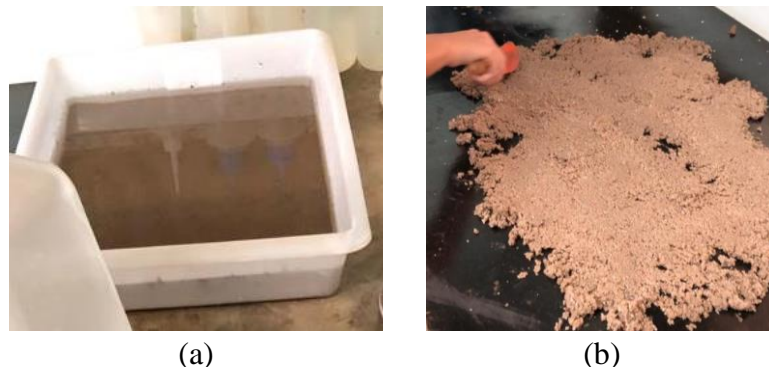
Figura 20 - Areia submersa em água (a); Areia espalhada para secagem (b).
