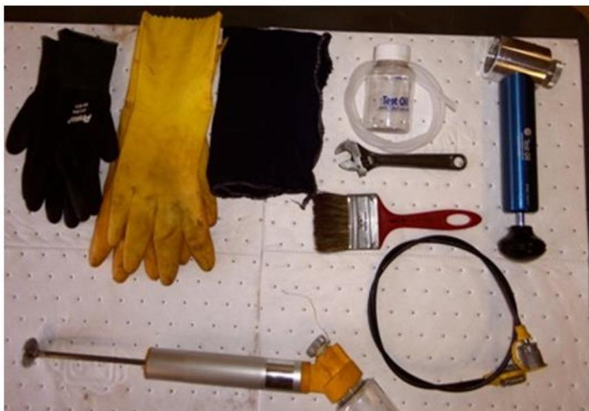
**Figura 5 - Ferramenta para coleta de óleo**
