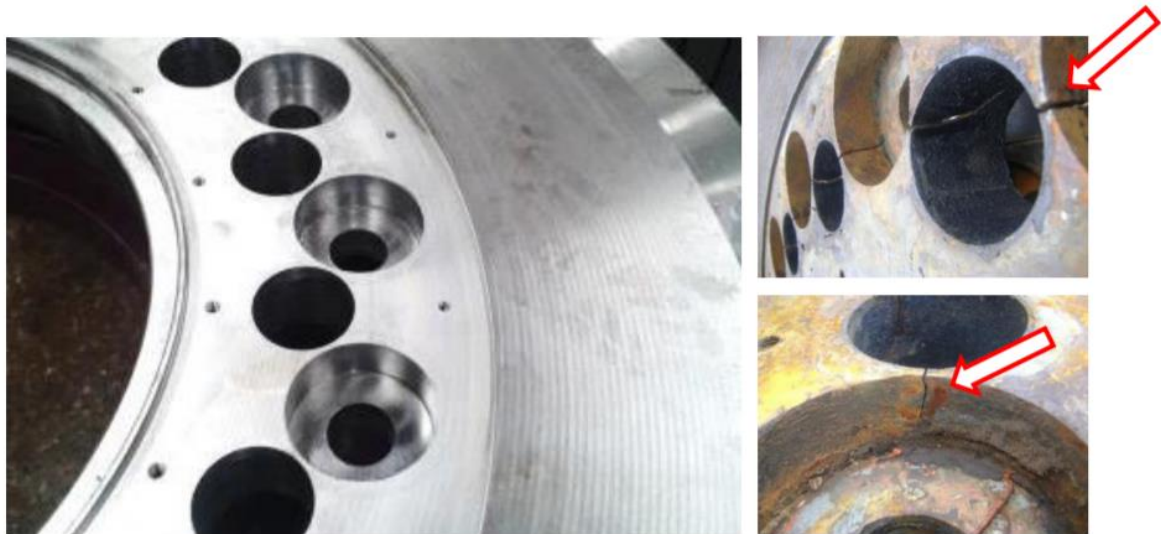
Figura 19 - Falhas por baixa espessura de parede.
