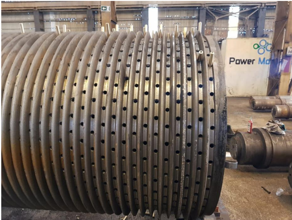
Figura 24 - Instalação das boquilhas no rolo lotus
