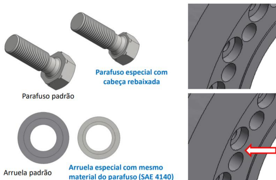
Figura 20 - Parafusos especiais com cabeça rebaixada.
