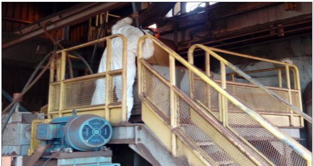
Figura 5 – Operador realizando limpeza com Ar Comprimido Fonte: Ito et al. (2018).
