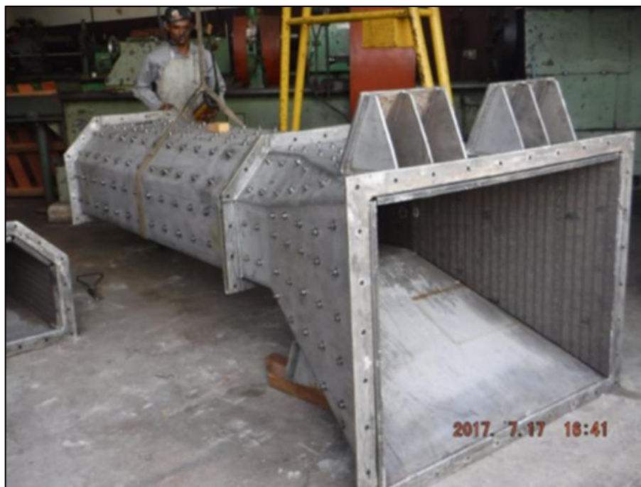
Figura 15 – Fabricação do tubo de alimentação finalizada Fonte: Ito et al. (2018).
