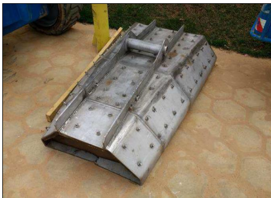
Figura 16 – Defletor do fluxo de minério Fonte: Ito et al. (2018).
