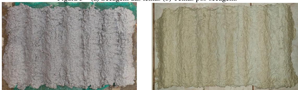
Figura 5 – (a) Secagem das telhas (b) Telhas pós-secagem.
