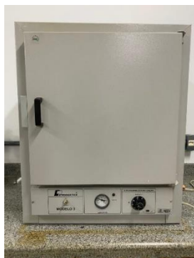
Figura 9 – Estufa de secagem com circulação de ar forçado.
