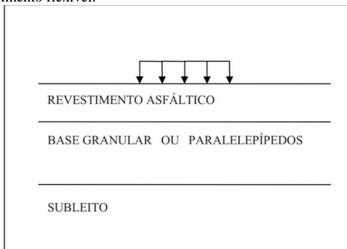
Figura 2- Estrutura de pavimento flexível.
