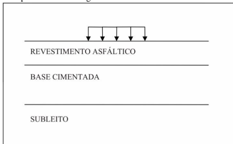
Figura 3 - Estrutura pavimento semi-rígido.
