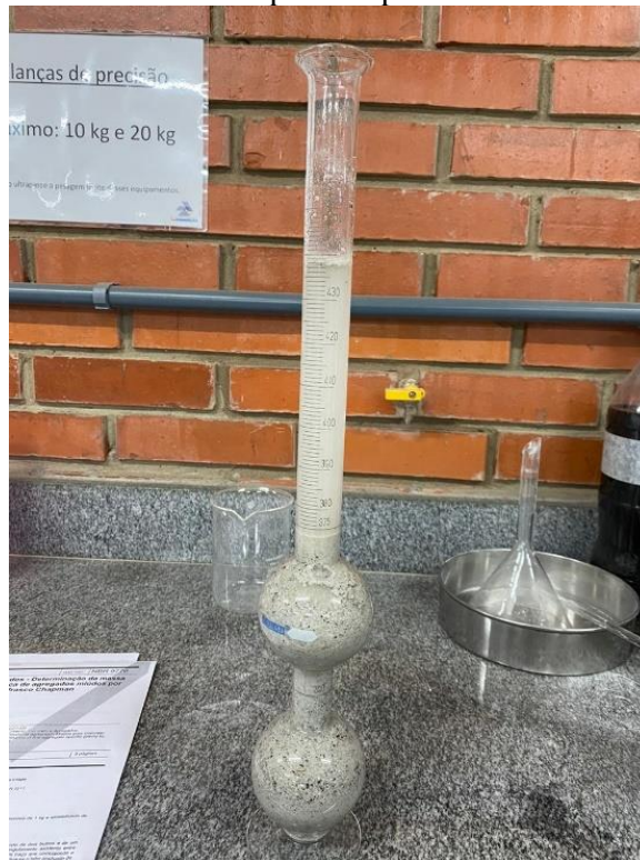
Figura 8: Ensaio de massa específica por meio do frasco Chapman.
