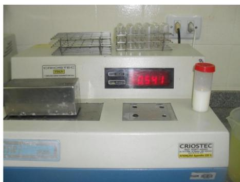
Figura 2: Crioscópio. Fonte: Toledo, 2015.
