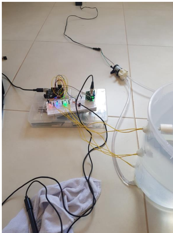
Figura 21 - LED'S demonstrando que o reservatório está cheio.
