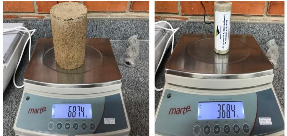
FOTO 2: ARGAMASSA COM VERMICULITA
