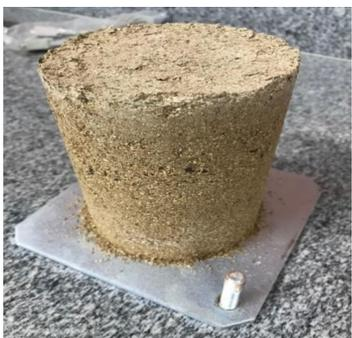
FOTO 1: ARGAMASSA COM VERMICULITA
