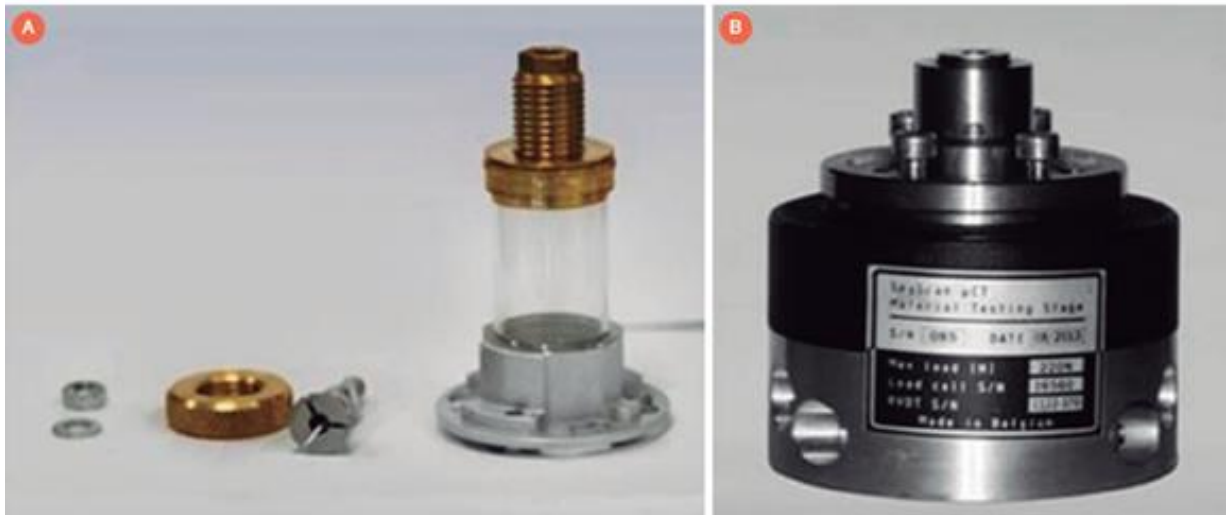
Componentes do dispositivo Materials Testing Stage acoplado ao microtomógrafo computadorizado 1174, para a realização de ensaios mecânicos. A- Disco superior. B- Disco inferior equipado com célula de carga de 222N.
