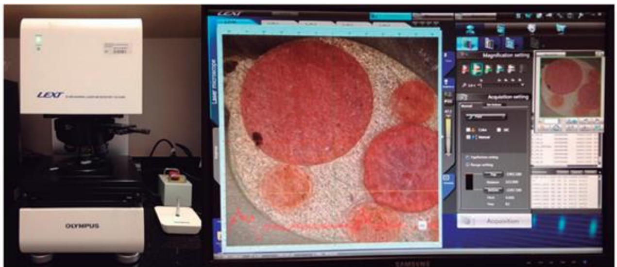
Microscópio Confocal a Laser 3D (Para este manual foi utilizado o Olympus LEXT OLS4000), utilizado na análise da interface dentina-material obturador.
