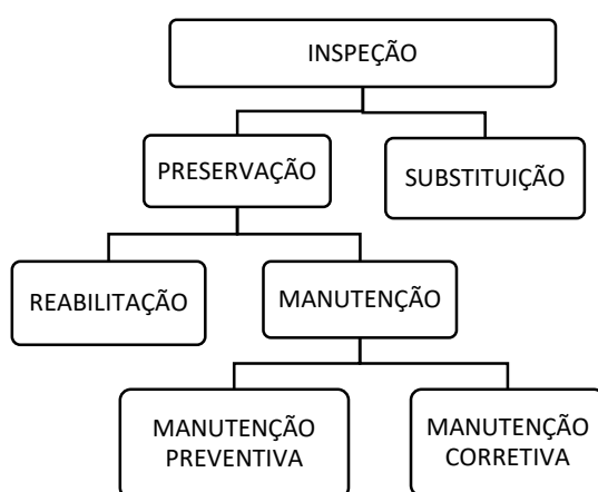
Fluxograma 1 - Processo de Inspeção da Ponte.
