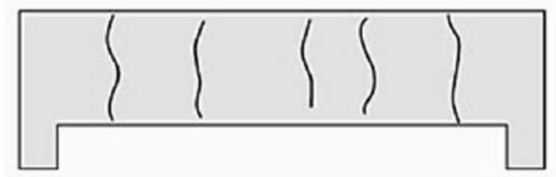
Figura 11. Trinca em viga por retração hidráulica.
