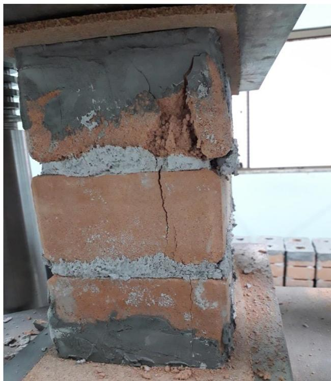
Figura 4.4. Prisma pleno após ensaio à compressão (Próprio autor, 2019)
