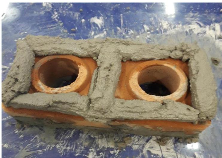
**Figura 3.11.** Montagem dos prismas com assentamento pleno (Próprio Autor, 2019)
