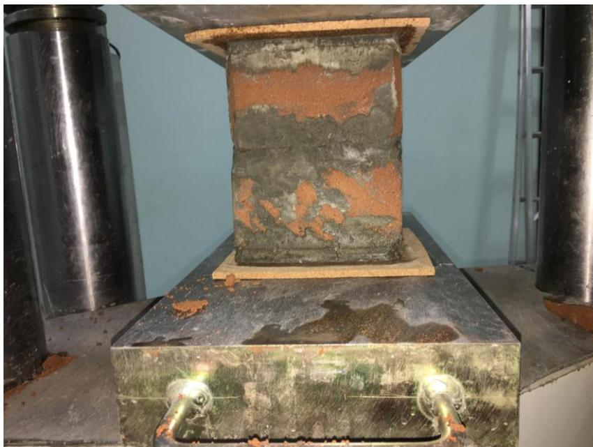
**Figura 3.6.** Lâmina de cortiça em ensaio de bloco (Próprio Autor, 2019)
