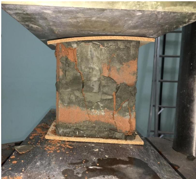
**Figura 4.2.** Tijolo rompido após ensaio à compressão (Próprio autor, 2019).
