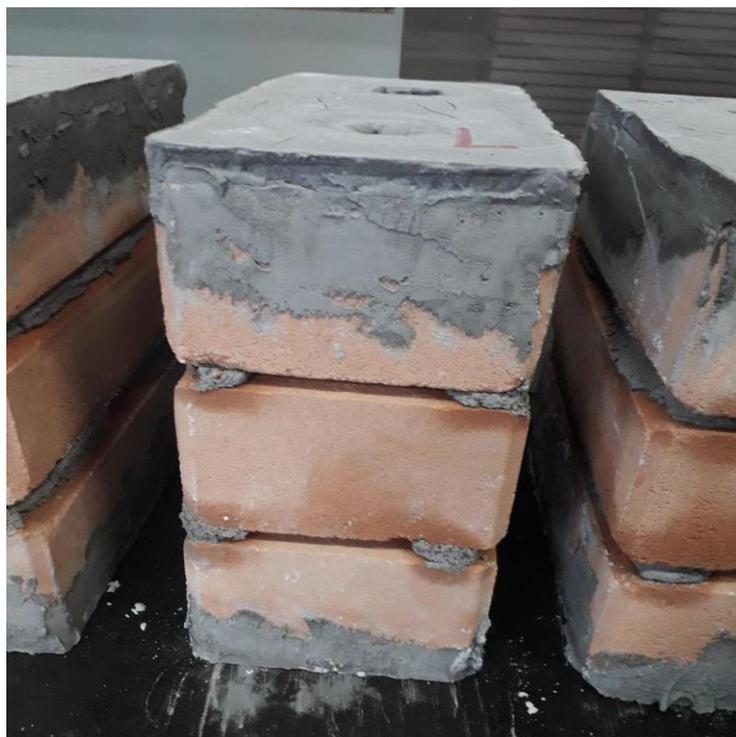
**Figura 3.10.** Prismas montados com assentamento longitudinal (Próprio Autor, 2019)
