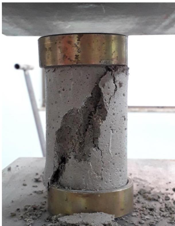
**Figura 4.5.** Corpo-de-prova após ensaio à compressão (Próprio autor)
