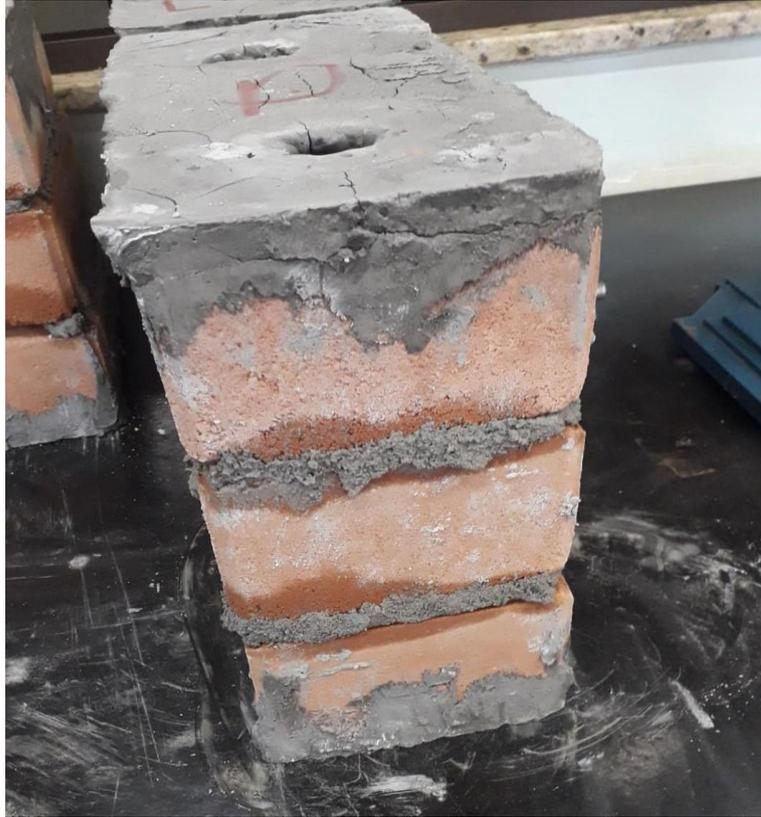
**Figura 3.12.** Prismas montados com assentamento pleno (Próprio Autor, 2019)
