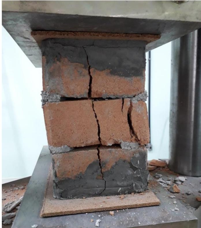
**Figura 4.3.** Prisma longitudinal após ensaio à compressão (Próprio autor, 2019)
