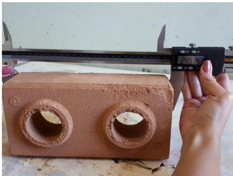
**Figura 3.1.** Dimensões do bloco (Próprio Autor, 2019)
