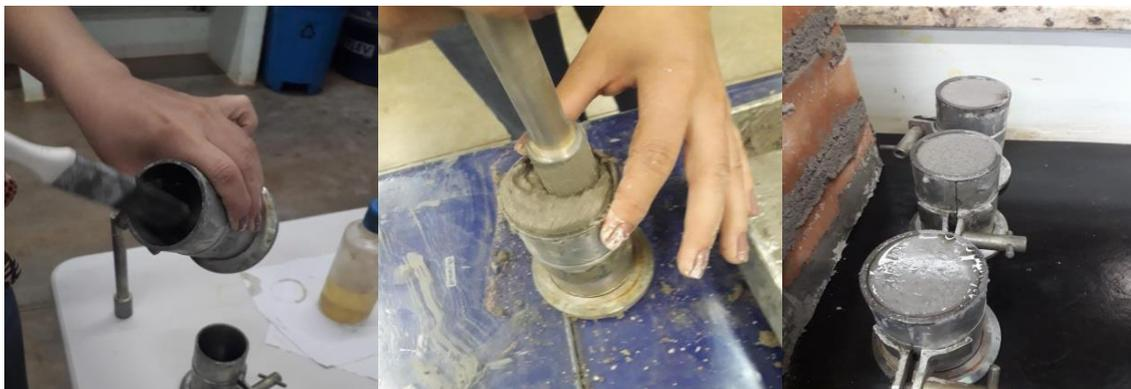
**Figura 3.8.** Processo de montagem dos corpos-de-prova (Próprio Autor, 2019)
