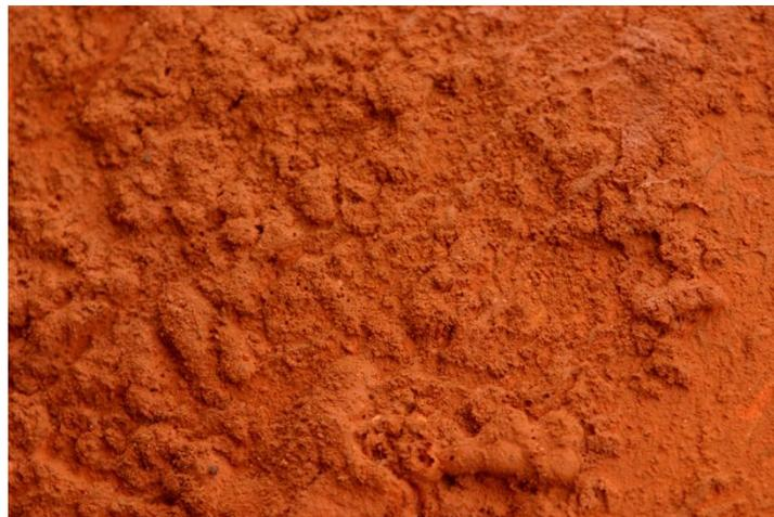
**Figura 2.5.** Solo adequado para utilização na mistura (Geoscan, 2017)
