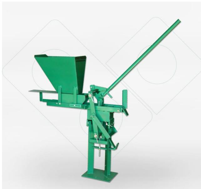
**Figura 2.8.** Prensa manual (Vimaq prensas, 2019)
