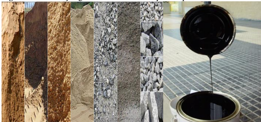
Figura 03 – Ilustração genérica dos materiais que compõem a mistura do CBUQ.
