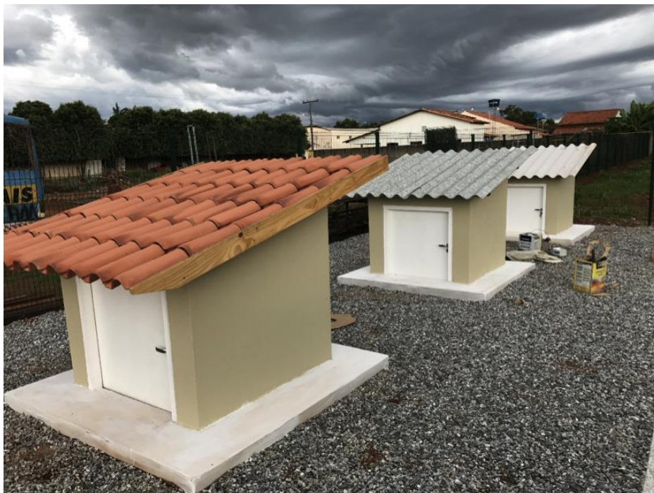
Figura 11. Célula teste com telha ecológica (Fonte: Acervo pessoal, 2017).
