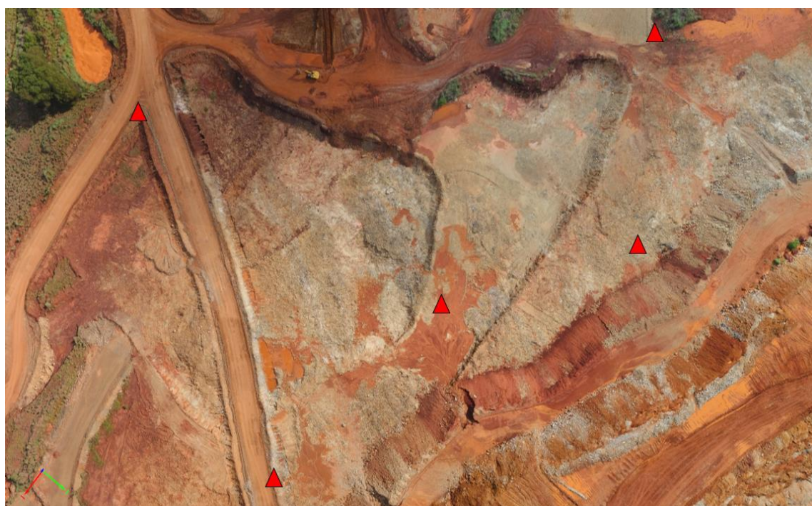
Figura 13: Disposição dos pontos de apoio utilizados no voo. Fonte: Arquivo pessoal.
