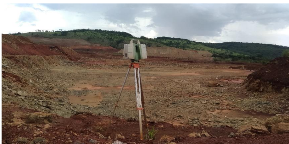
Figura 15: Posicionamento do LASER scanner para realizar o levantamento. Fonte: Arquivo pessoal.
