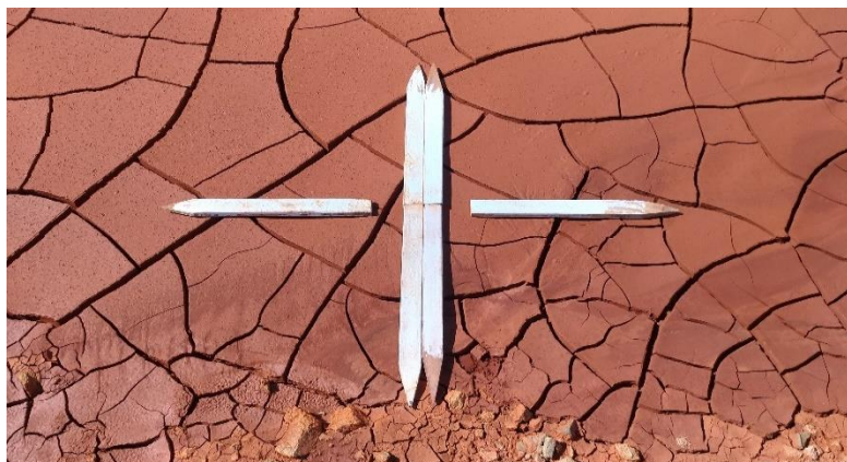
Figura 12: Modelo dos pontos de apoio utilizados no levantamento. Fonte: Arquivo pessoal.
