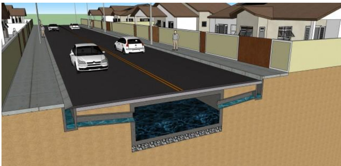
Figura 14 - Sistema de Macro drenagem
