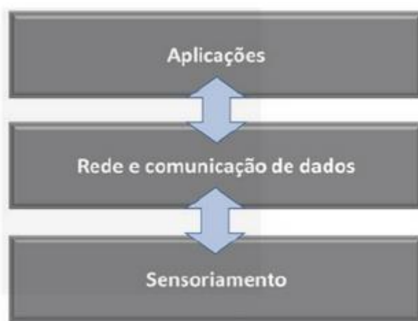
Figura 1 - Arquitetura da IoT conforme IEEE P2413
