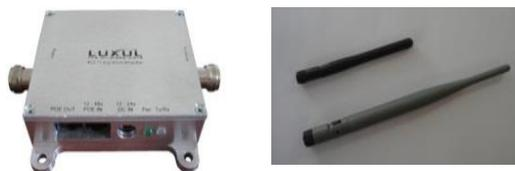
**Figura 5 - Antenas omnidirecionais**
