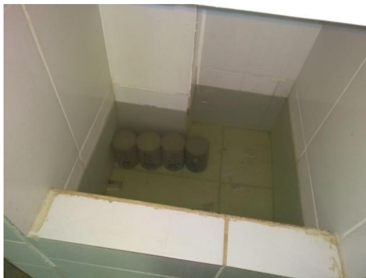
Figura 17 – Cura submersa em tanque com água potável
