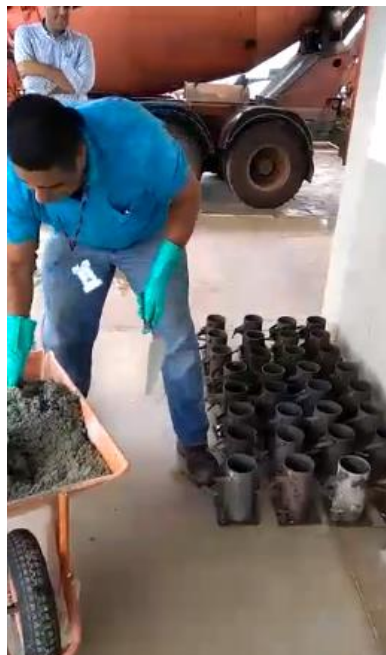
Figura 16 – 32 moldes metálicos e início da moldagem dos corpos de provas
